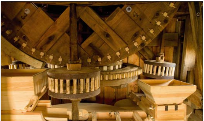
Bockmühle Wenden, zusätzliches Vorgelege für zwei weitere Mahlgänge
